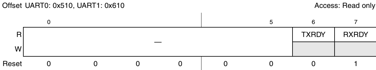
Figure 12-15. DMA Status Register (UDSR)
